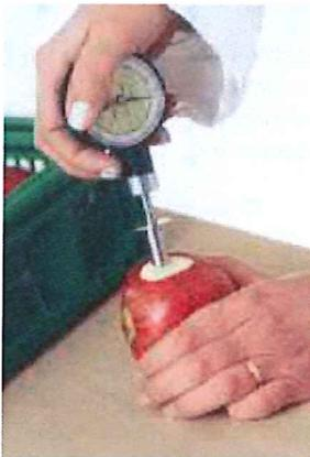
Utilisation d'un pénétromètre
