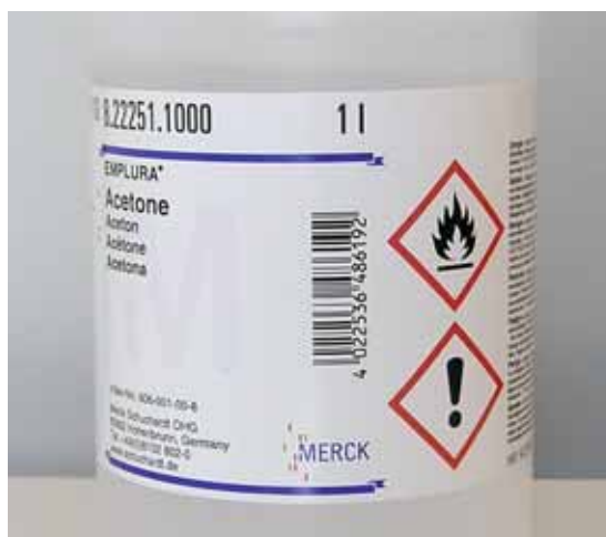
Fig. 10: exemple d'étiquette avec pictogrammes de danger.
