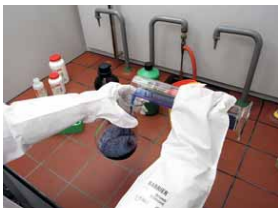
Fig. 13: il faut utiliser des gants de protection résistants aux produits chimiques pour manipuler des substances nocives pour la peau et pénétrant facilement par la peau.
